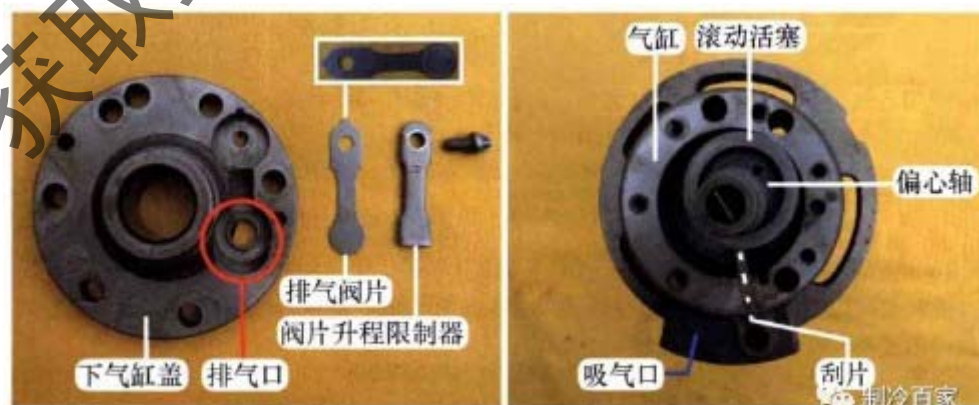
图 5-47 下气缸盖组件
