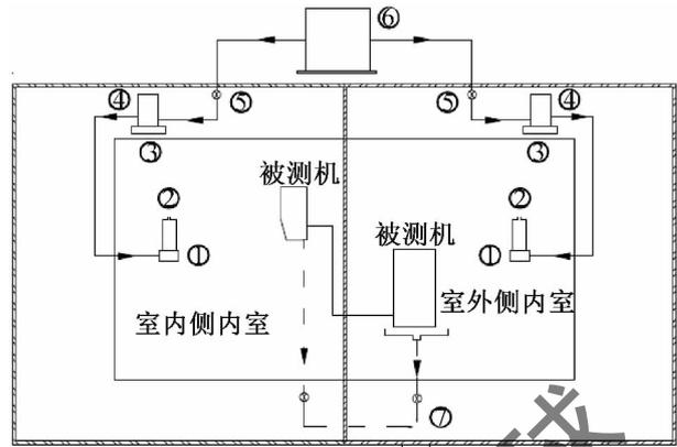
1 电力测定 2 加湿器 3 高位电子秤 4 加湿器进水箱
