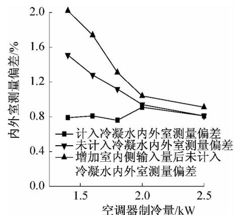
图 4 制冷量测量偏差
