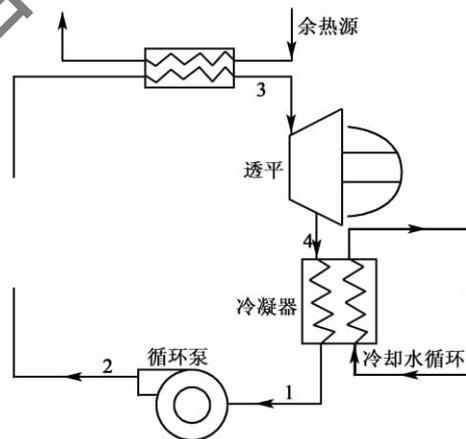
图 1 有机朗肯循环系统示意图
