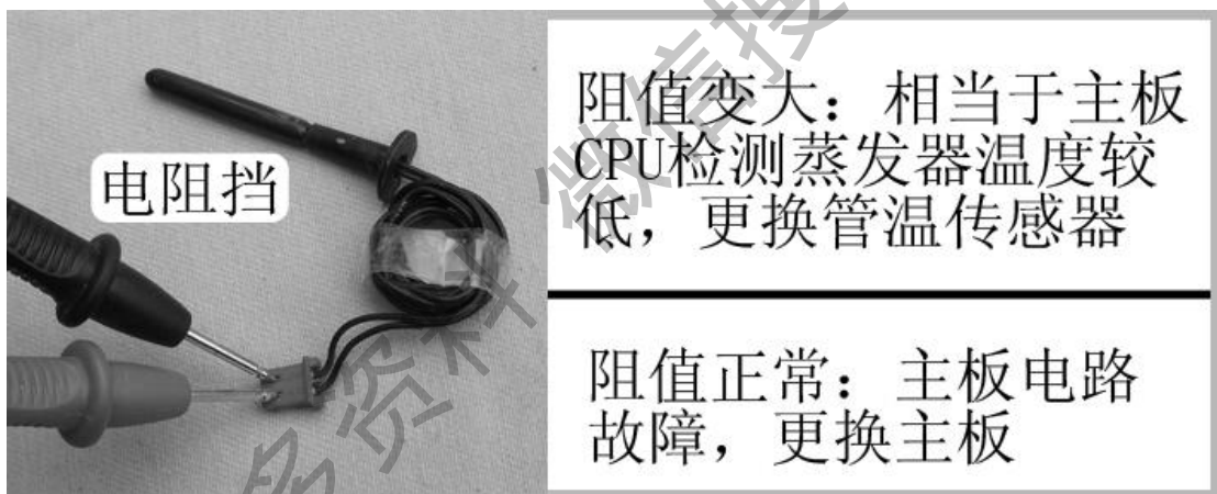
图 5-20 测量管温传感器阻值
