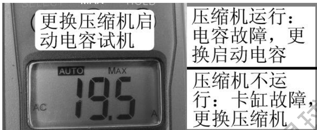
图 5-30 运行电流很大故障的检修方法
