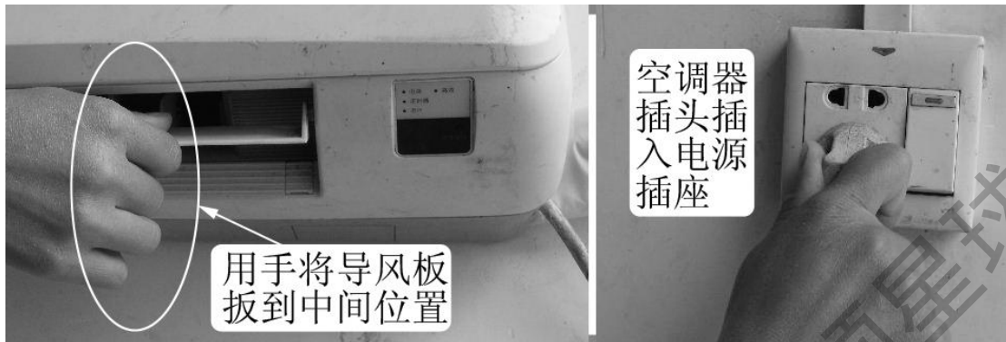
图 5-2 导风板扳到中间位置并通上电源
