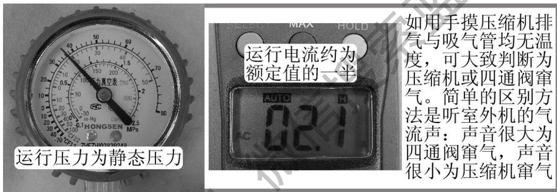
图 5-40 运行压力为静态压力、运行电流为额定值的一半
