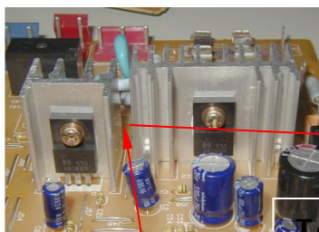
IC2: 12伏稳压源 IC6: 继电器控制 室外机风速继电器
