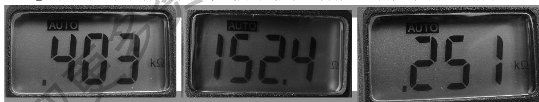
4-38 室外风机线圈的三种阻值结果
