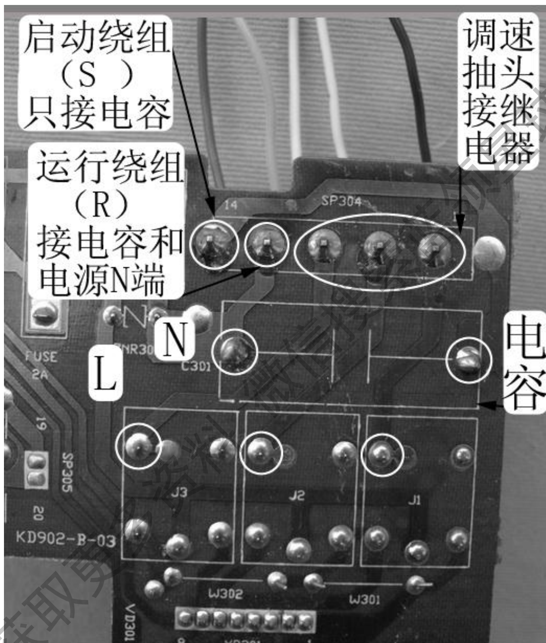
图 4-28 根据主板引线判断抽头电机线圈引线功能
