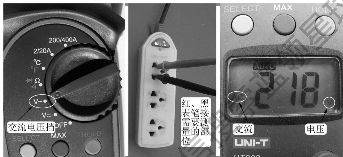
图 4-4 测量交流电压
