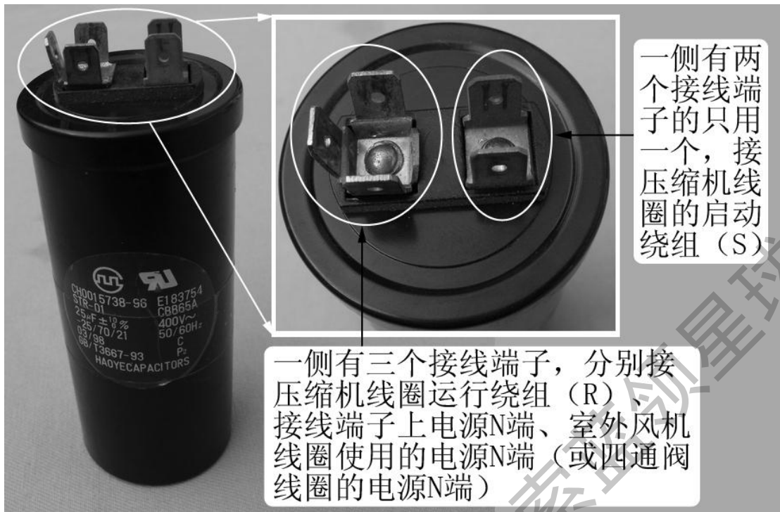
图 4-33 压缩机电容接线端子功能
