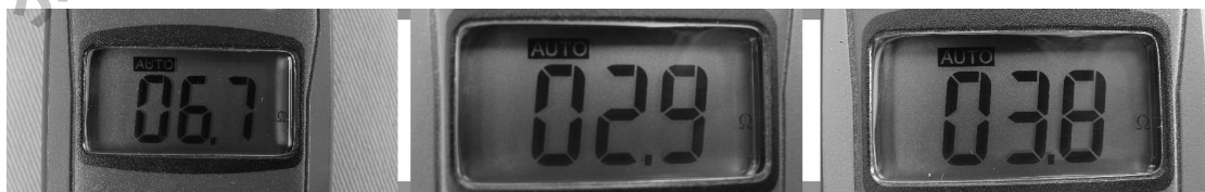
图 4-44 压缩机线圈的三种阻值
