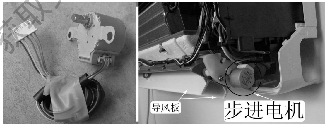
图 4-16 步进电机及在室内机的安装位置
