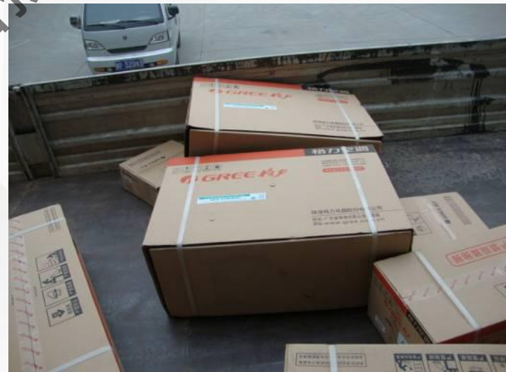
外机器侧放或倒置易损坏机器
