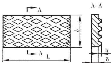
基本厚度  $\delta=6$  mm, 宽度  $b=1\ 000$  mm, 长度  $L=4\ 000$  mm 的菱形花纹钢板的标记示例:
