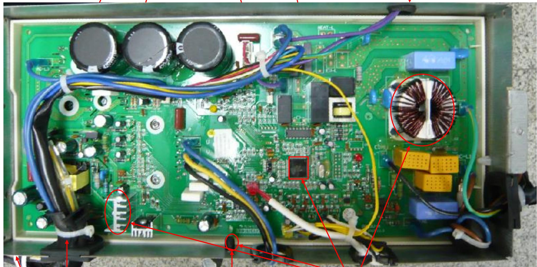
用电器盒内的固线勾将此处的环境感温包、风机和电抗器线固定，形成一个滴水弯。过线胶圈用线扎扎紧，避免进水
