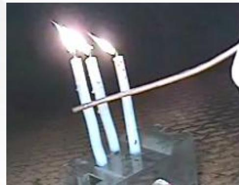
**结论：R32制冷剂离开火源后自动熄灭**
