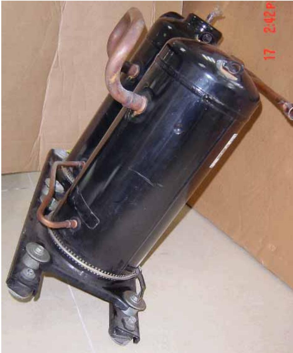
将压缩机放正后，拔掉其余接口橡皮塞，马上将其连接管路（排气管、吸气管及气平衡管，其中数码压缩机还包括卸载管路件）焊接上。橡皮塞拔掉后，不能将压缩机长时间放置，否则会有水分进入。在焊接管路时，一定要保证充氮焊接，氮气压力为  $1.0\sim 3.0\text{kgf/cm}^2$ 。
