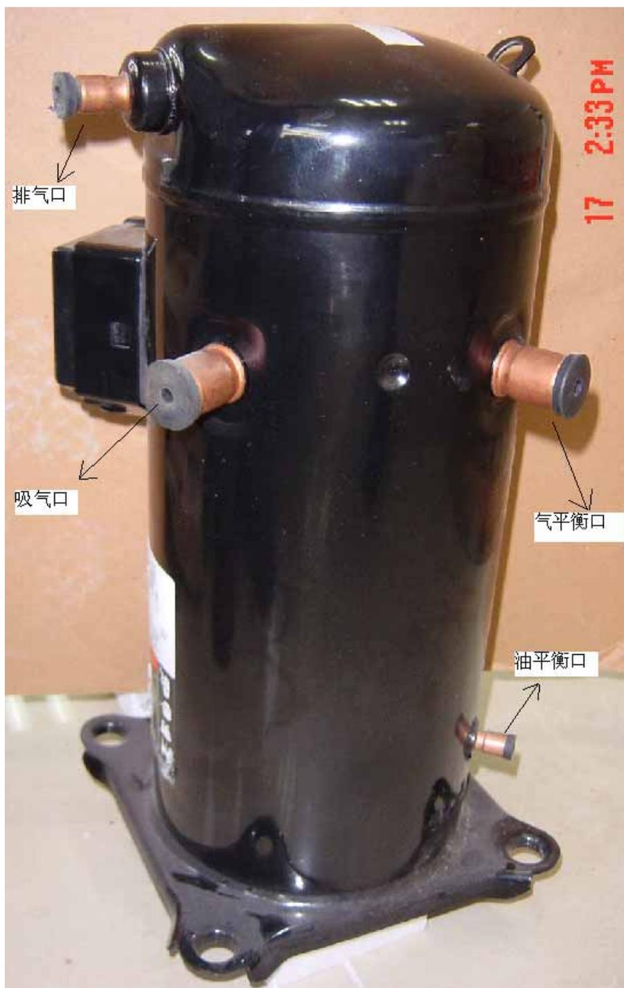
油平衡管橡皮塞拔掉后，要马上将油平衡管焊接上，然后再将压缩机放平
