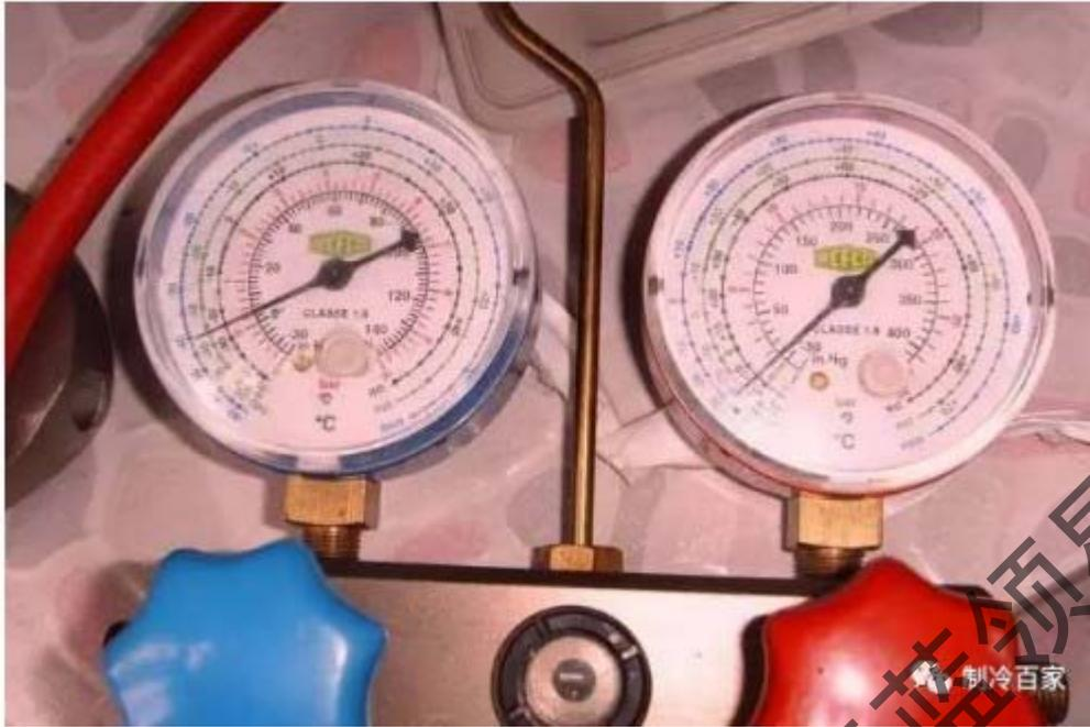
将压力表用蓝管和真空泵相连，外机的气管(粗管)三通阀修理口用红管接上压力表，检查各连接是否上紧了。
