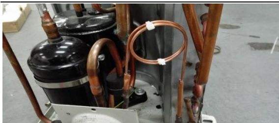
6、用扎带和阻尼块包好焊接好的毛细管
