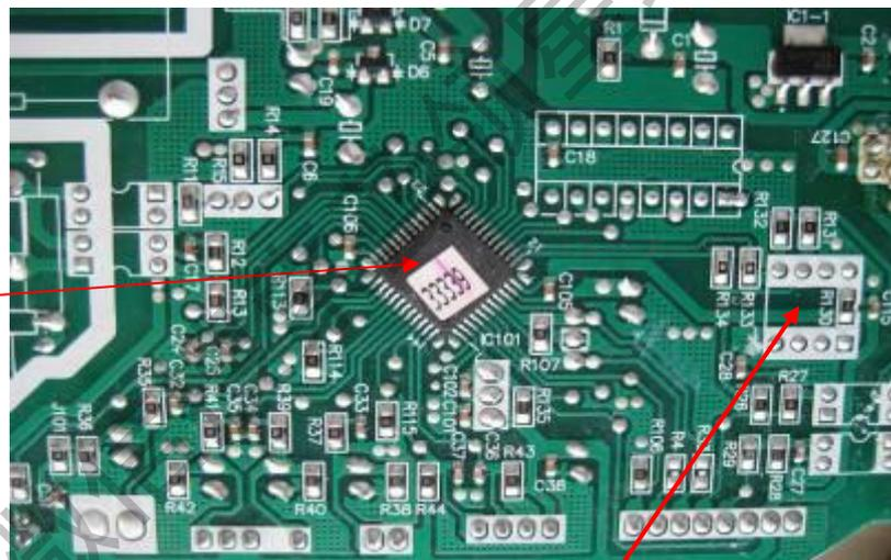
参数程序，储存控制芯片参数
