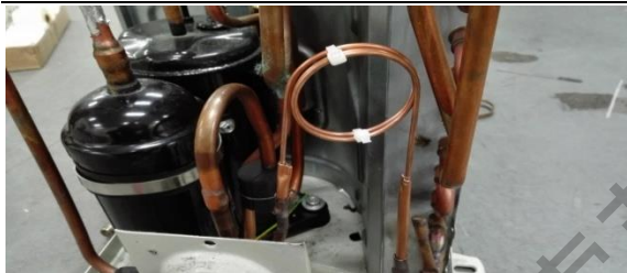
6、用扎带和阻尼块包好焊接好的毛细管
