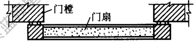
图 6—50 外贴式冷库门示意图
