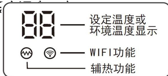
化霜时“辅热”灯闪烁，清洁时温度区显示“CL”；进入查询时“辅热”灯闪烁；所有具有温度显示功能的机型：
