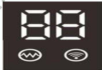
2、本功能说明书显示部分为两位七段LED数码管(简称双8)+2个LED灯 显示；两位数码管在不同的情况下分别显示设定温度及故障代码；2个LED灯分别表示：辅热、WIFI。
