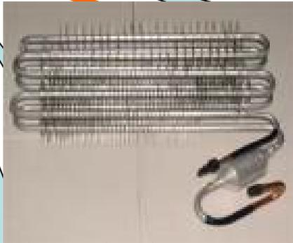
放热，使高压高温制冷剂蒸汽冷却、冷凝成高压常温的制冷剂液体
