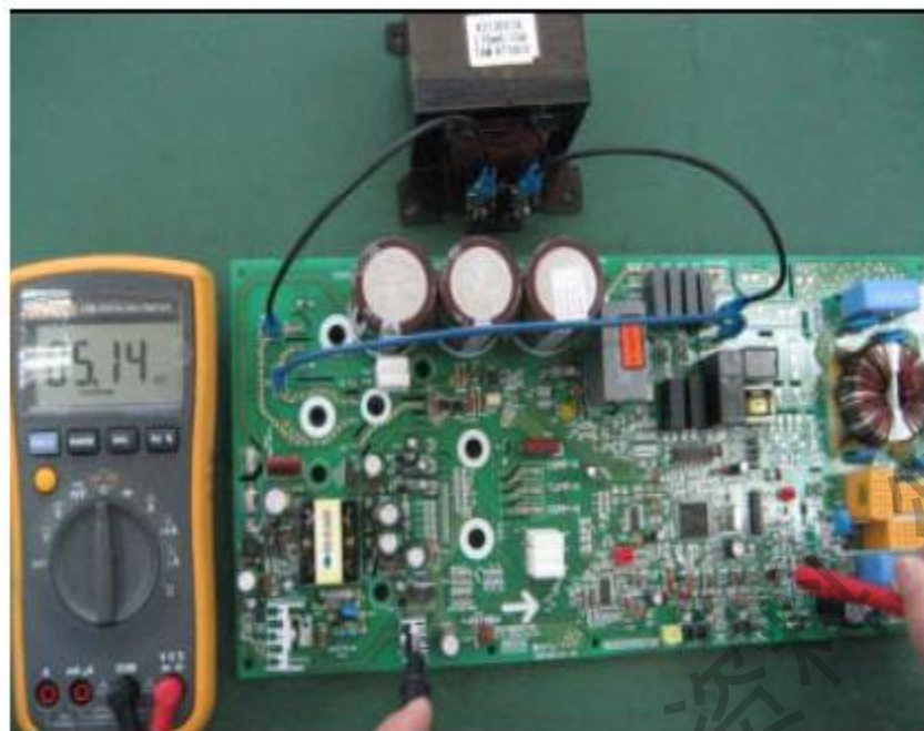
图 41：主芯片直流电压测量。 正常值：3.2-3.3V 左右。 错误值：远小于 3.2V。
