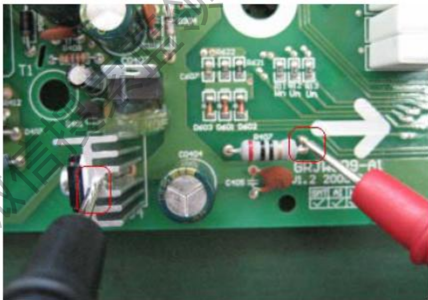
图 40: 继电器电压测量具体位置。 红表笔: R407 右端。 黑表笔: U404 散热器。
