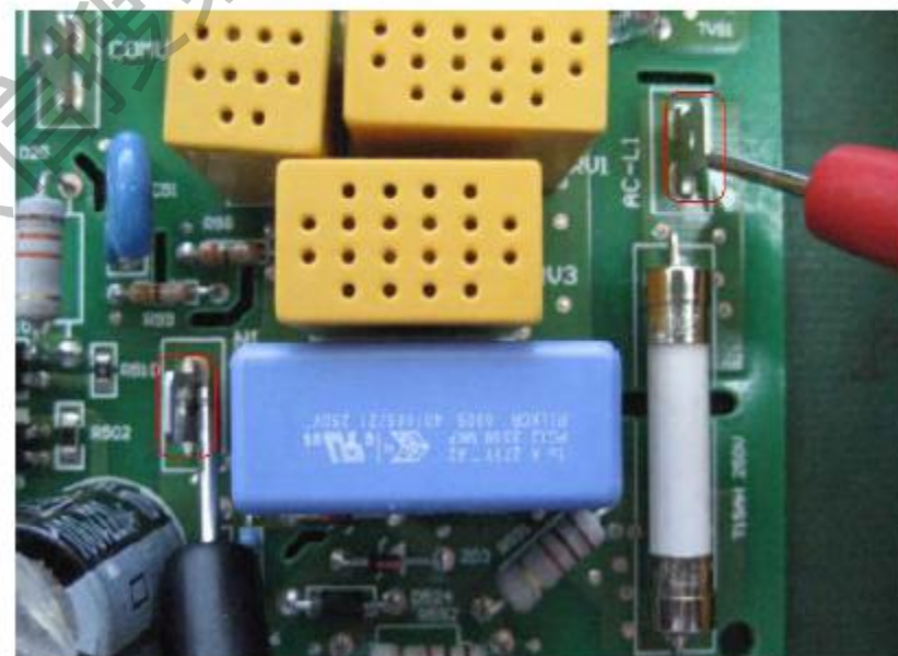
图 19: 测量火线与零线之间是否有短路
