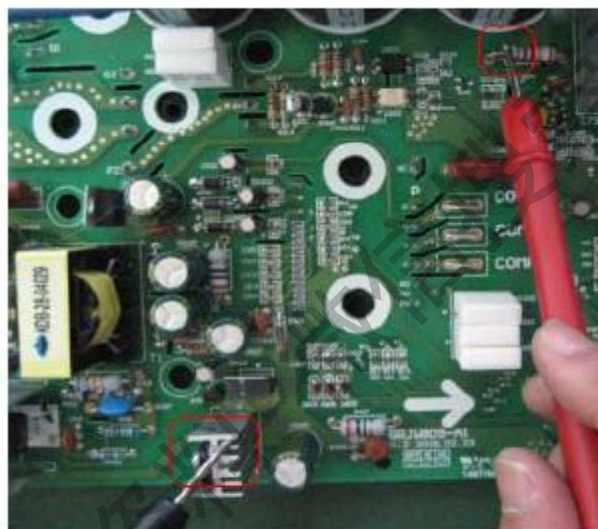
图 35: 母线电压测量。 黑表笔与 U404 散热器接触。
