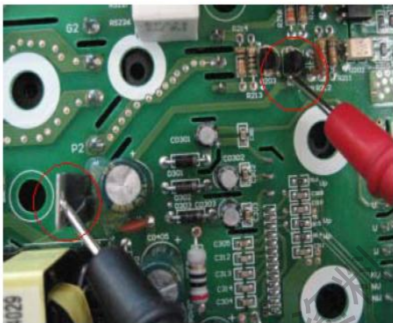
图 37：PFC 15V 直流电压测量。 正常值：直流 15V。 错误值：远小于 15V。
