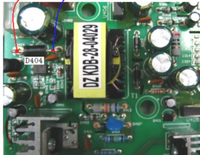
图 17：故障品二极管压降
