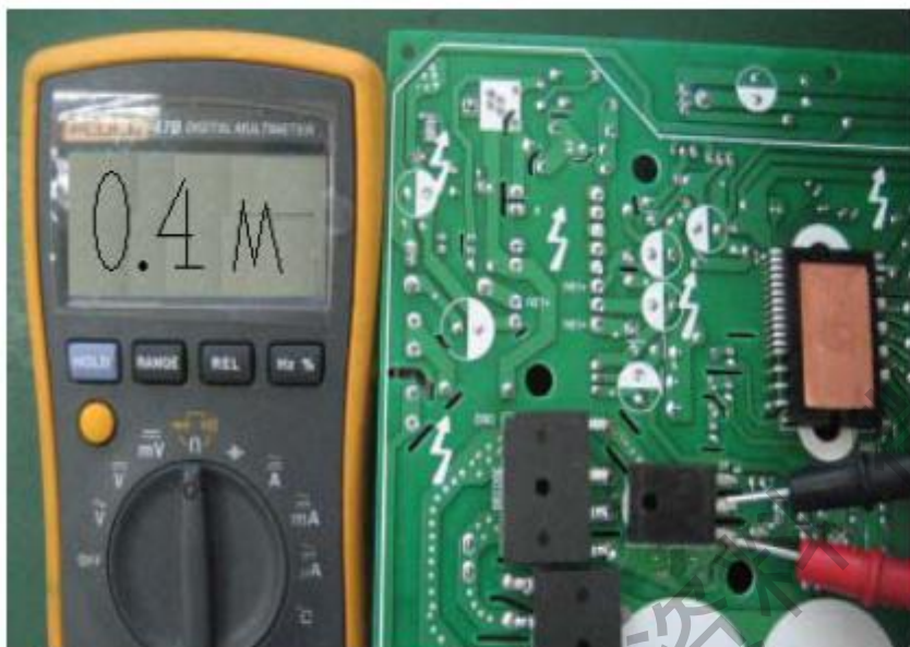
图 30：IGBT 漏极与源极测量 正常值：约 0.4\text{M}\Omega 错误值：基本为短路状态。
