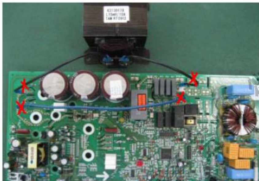
图 20: 断开电感连线与跨接零线。
