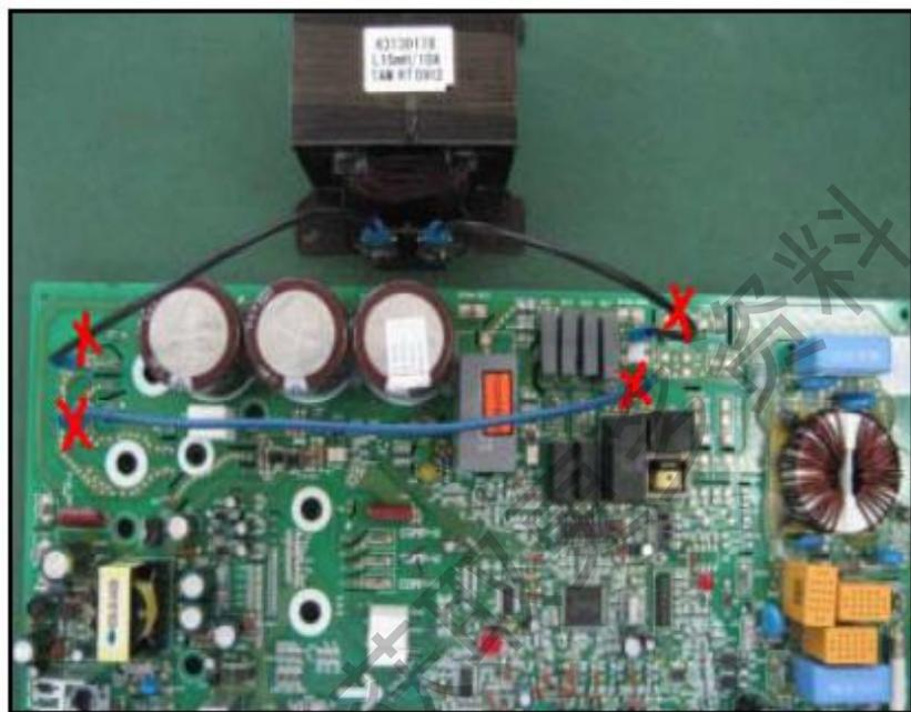
图 22: 断开电感连线与跨接零线。
