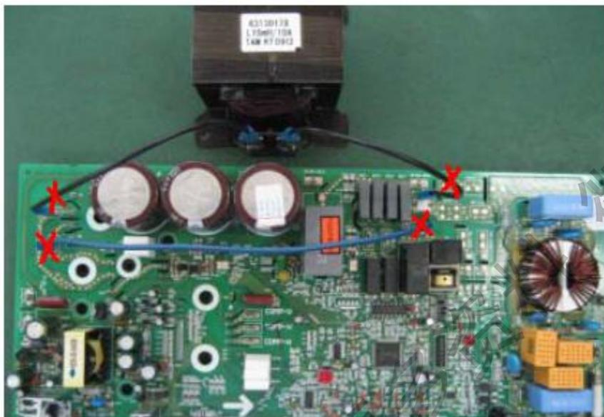
图 20: 断开电感连线与跨接零线。
