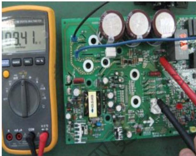
图 54：P 端与 W 端电阻测量
