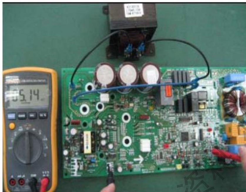
图 41: 主芯片直流电压测量。
