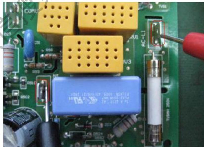
图 19: 测量火线与零线之间是否有短路
