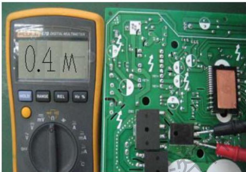
图 30：IGBT 漏极与源极测量
