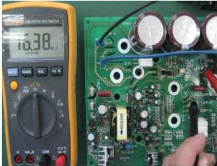
图 56: P 端与 U 端电阻测量
