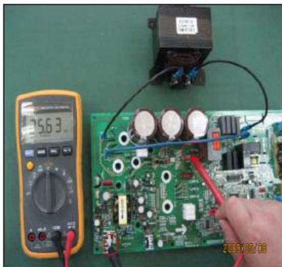
图 34: 母线电压测量。
