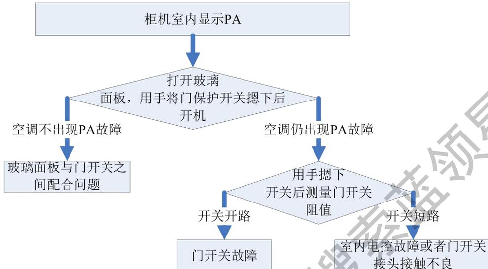
2、玻璃门系列柜机出现“PA”门格栅保护故障具体排查步骤如下：
