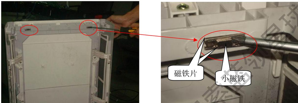
2、将进风格栅上原有的两个磁铁片放入磁铁槽中后并分开（注意：操作过程中请将进风格栅放置到干净的纸皮或者柔软的物料上面，避免操作过程中划伤进风格栅表面），具体如下图所示：
