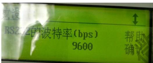
通讯接口: RS232 (可以直接插上 485 转换头, 位置合适)
