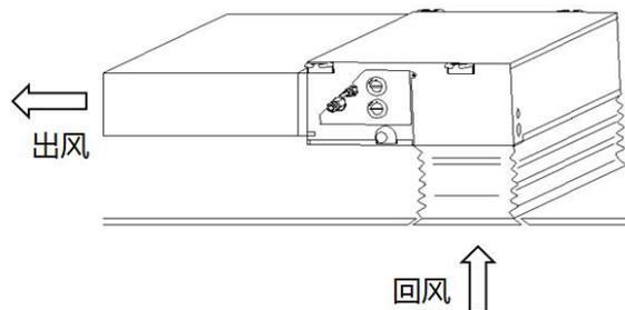
因机组静压为10Pa，出风口、回风口风管的尺寸尽可能短，最长不要超过2.5
