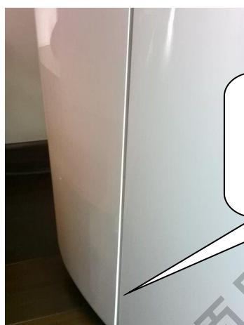
KF 双贯流柜机面板在拆卸周转过程中需要轻拿轻放，且需要拿中间部位，否则铝合金面板一端容易变形，从而造成开关门闭合间隙大等现象。
