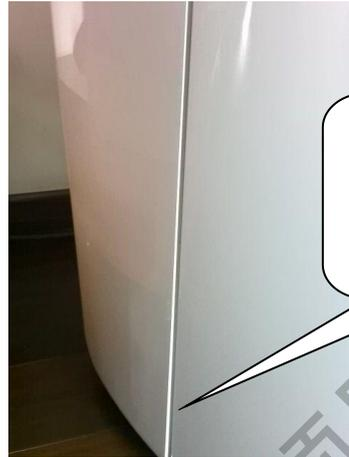
由于左图错位导致开关门无法闭合或缝隙大。
