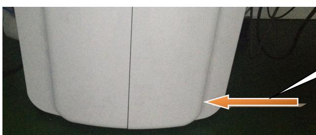
2、如果右侧门高出左侧门，请从左往右轻推左侧门下端，直到推不动为止，然后断电重新再上电让门自动复位即可。
