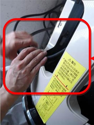
2)、将排水管、输入输出管和电线分别掰到外面，并放到掰掉挡块的缺口中；
