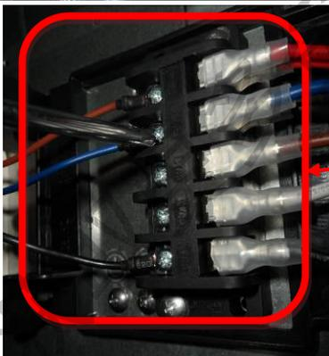
3)、拆下三根检测线；
