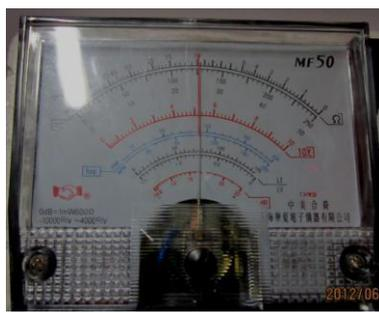
指针表**直流50V电压档**测量
