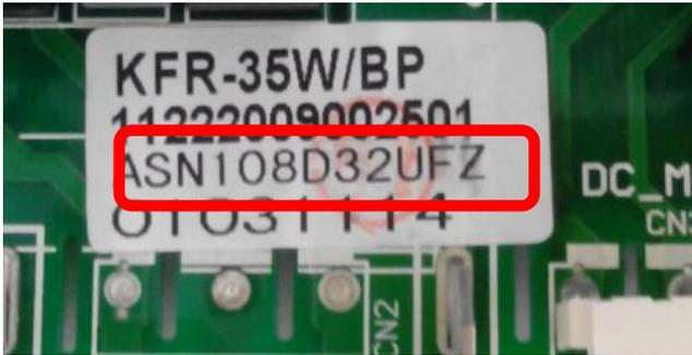
2、目前空调挂机产品使用压缩机型号中拨码 1、2、3、4：与压缩机匹配选择对应关系图片如下：
