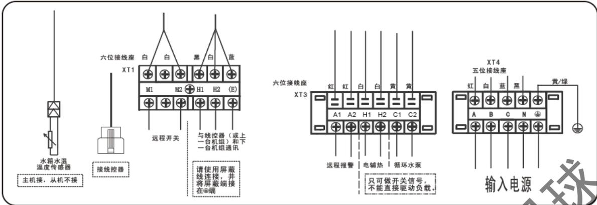
RSJ-220/SN1-540V-D 电气连线简图
