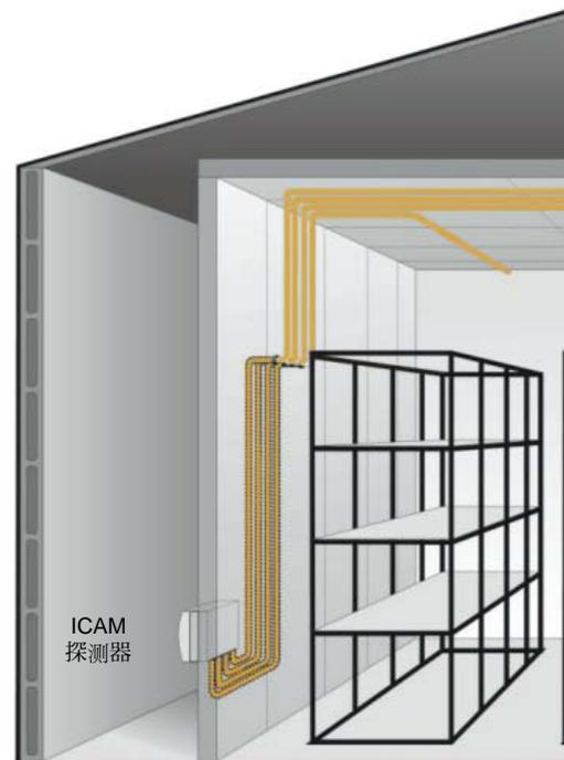
图 3 - 将 ICAM 探测器安装在保护区外部
