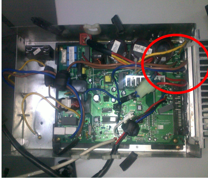
无源PFC方案室外电控盒全景图
