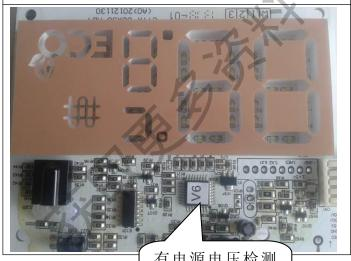
有电源电压检测 功能的显示板,软 件版本号是 V6。
