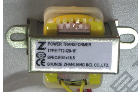
图 4: 新方案变压器: TT2-I28-1F
