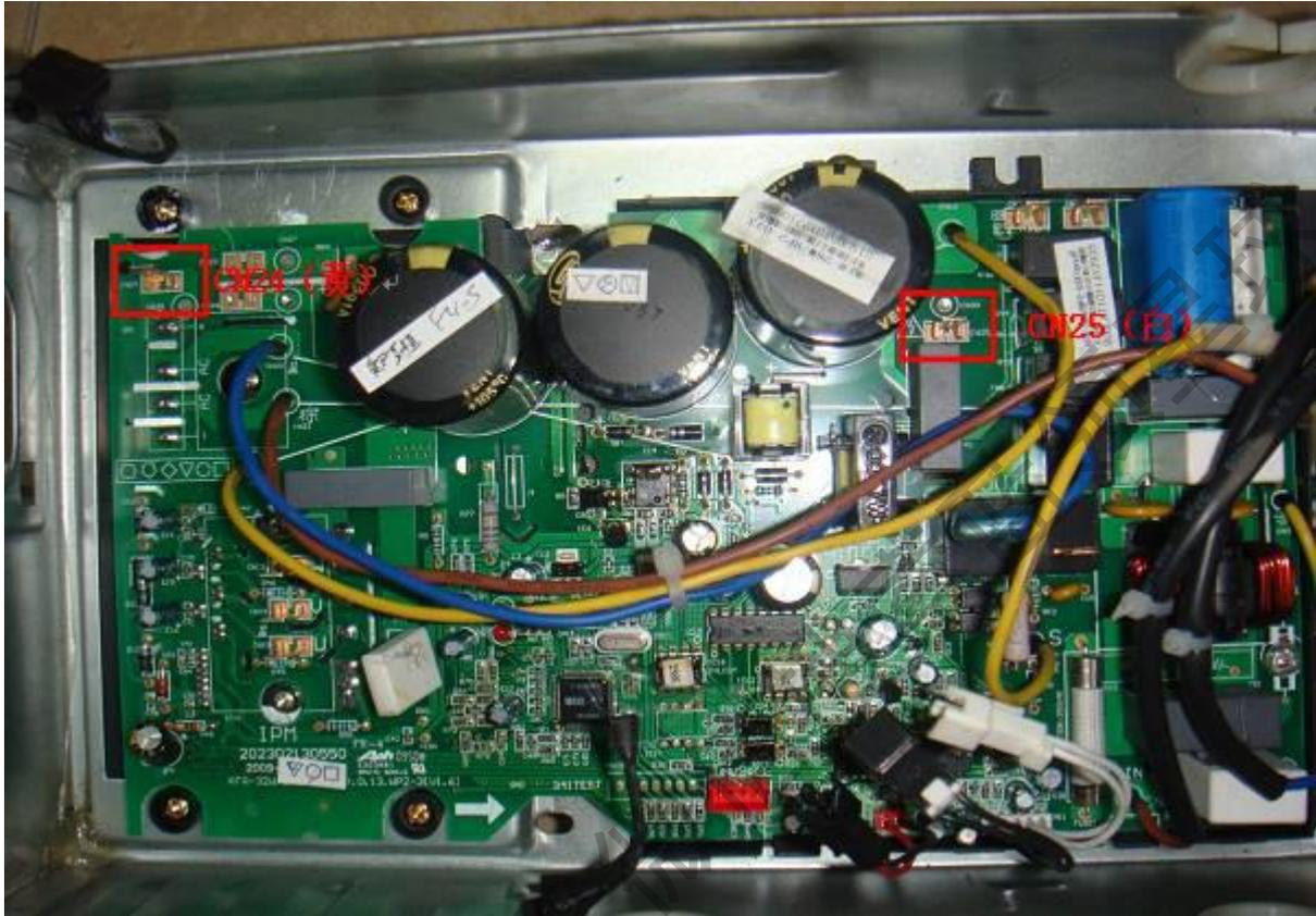
上图红色方框中两个单插片 CN24、CN25 即为单电抗器和交流电容的接线端子。在电控板上印有汉字丝印，分别为黄、白，与对应强电连接线组（连接电抗器和交流电容的连接线）的颜色对应。
