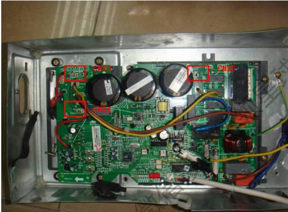
上图红色方框中三个单插片 CN23、CN24、CN25 即为双电抗器和交流电容对应的接线端子。
