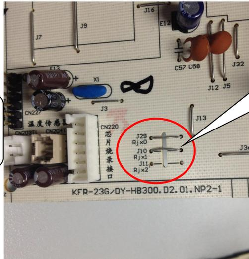
定速机的板有 3 根机型选择跳线。
