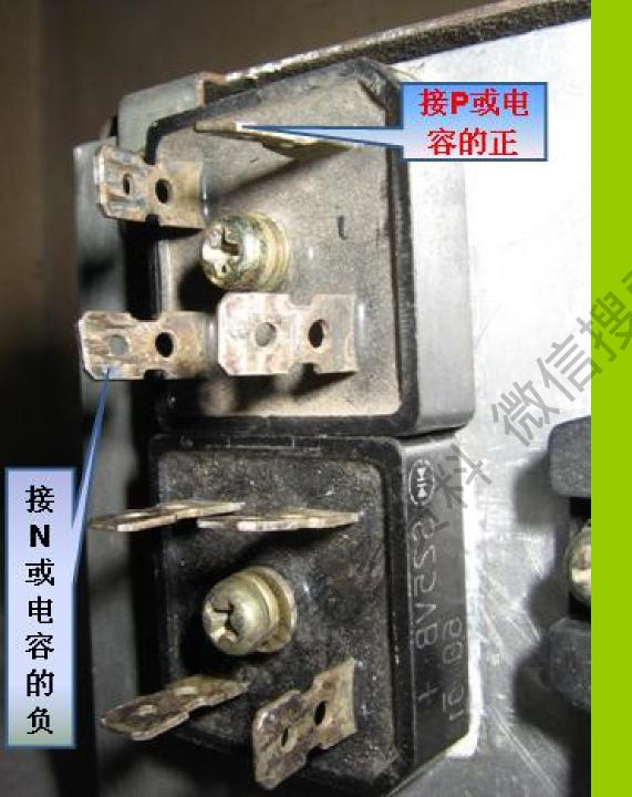
硅桥里面就四只大功率的二极管, 特性和一般的二极管一样。正向导 通,反向截止!也就是说正向观察 阻值大约500Ω,反向阻值无穷大。
