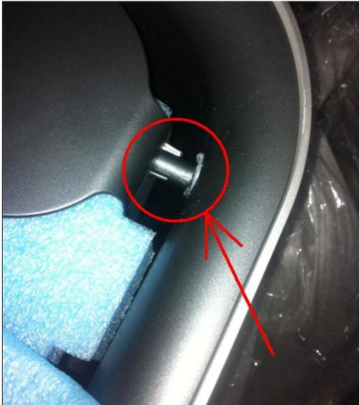
2、如拆开后发现横格栅脱出白色轴套以外，则需将横格栅防护包装棉去掉，然后用一只手顶住脱出的一端，另一只手轻微弯曲横格栅中部，最后将横格栅脱出的一端装进轴套中即可。
