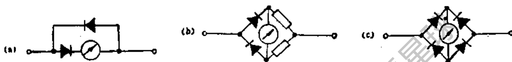
图8-12 整流式仪表电路
