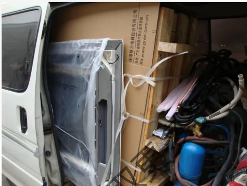
拆箱后裸机装车易造成机器损坏
