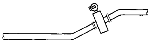
图 5-4-25 电磁流量计的安装 (二)
