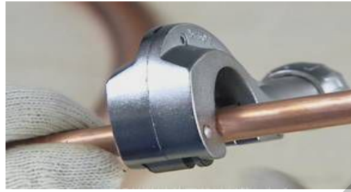
使用的专用的工具切割铜管（正确）
