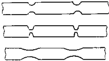
图 7.9.3 不同槽口的熔体
