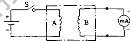
图 1.1.26 用冲击法测定同名端
