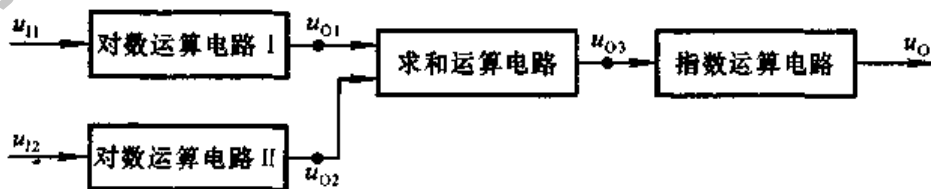
图 7.2.29 利用对数和指数运算电路实现的乘法运算电路的方框图
