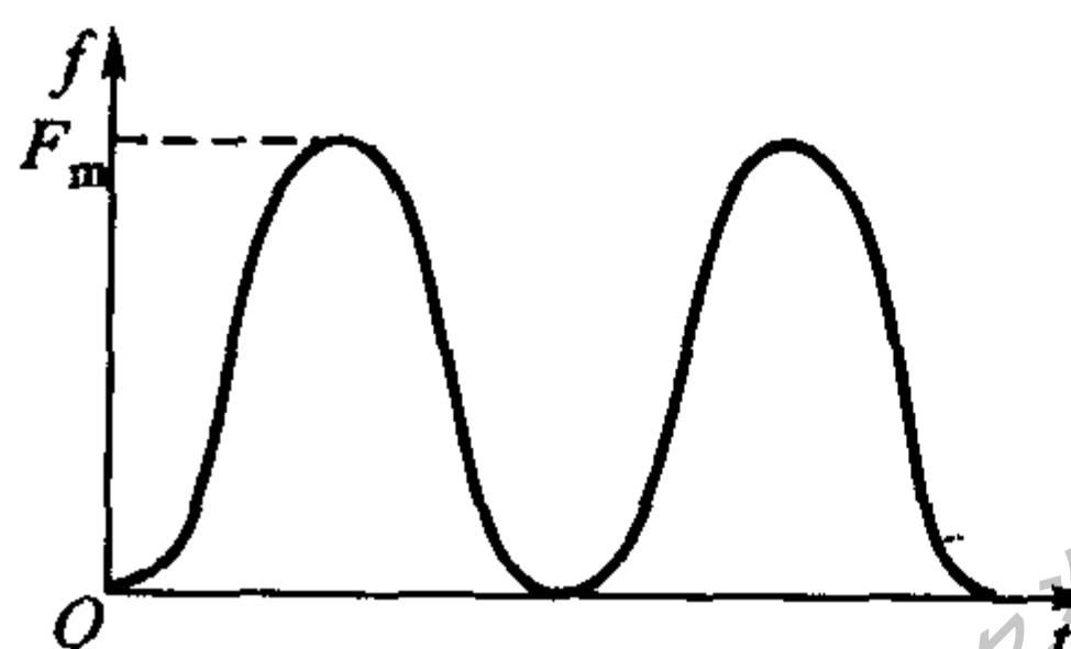
图 6.4.3 交流电磁铁的吸力
