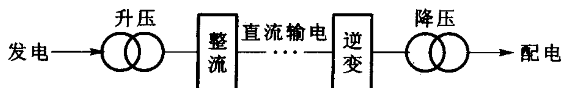
图 12.1.4 直流输电结构原理图
