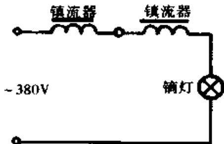
(c) 用高压汞灯镇流器代用管形钠灯工作线路 (d) 与漏磁变压器配套管形钠灯工作线路
