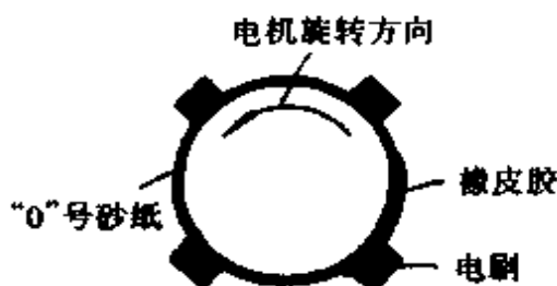
图 4.3.16 电刷研磨示意图
