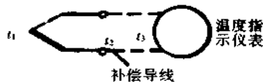
图 5.6.14 热电偶连接补偿导线的电路
