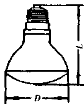
图 5.8.10 红外线灯泡外形图
