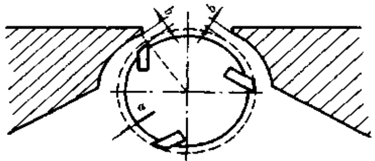
图 4.5.16 刀轴与刀腔结构示意
