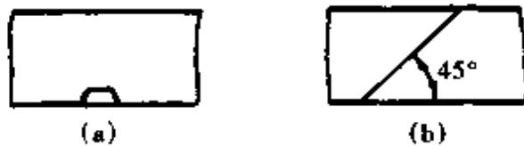
图 4.3.30 换向极线圈局部修理 (a)局部修补 (b)换接导线
