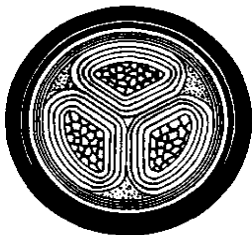
图 6.1.18 三芯油浸纸绝缘电力电缆结构
