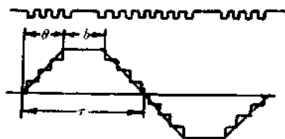
图 4.1.10 等槽等匝分布时磁场磁势波形分布图
