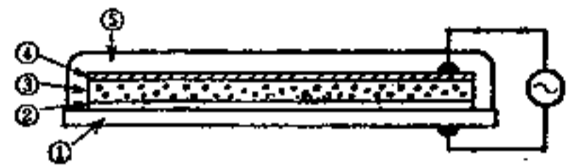
图6-125 EL的典型结构(陶瓷EL) ①铁基板；②电介质层；③发光层；④透明导电层(nesa膜)；⑤防潮层(玻璃)
