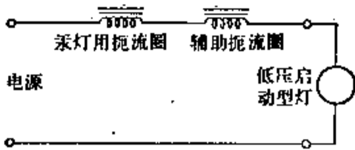
图6-115 一般型(在汞灯扼流圈上串联辅助扼流圈的回路) (200V, 250W)
