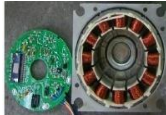
无刷直流电机内置驱动板及定子
