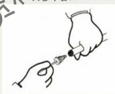
4. 管口向下用小毛刷清理管内铜屑
