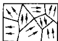
① 在没有外磁场作用时,铁磁材料的磁畴排列杂乱无章
