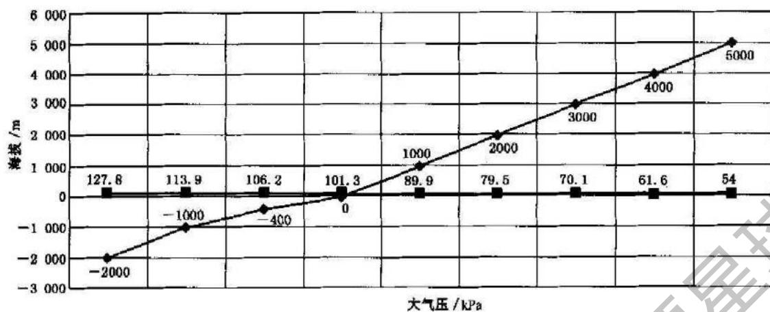
图 1 b) 5 000 m 以下海拔高度与标准大气压力的对应关系图
